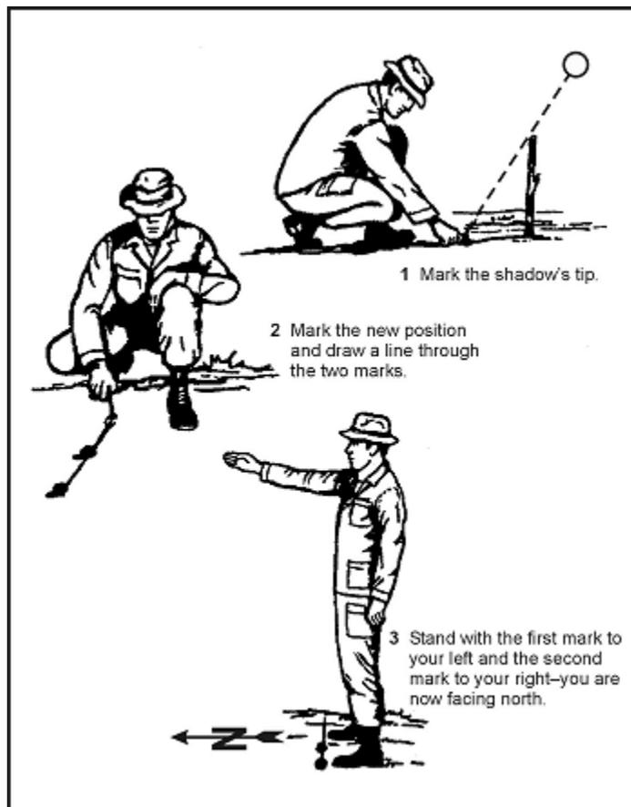
**Figure 18-1. Shadow-Tip Method**
