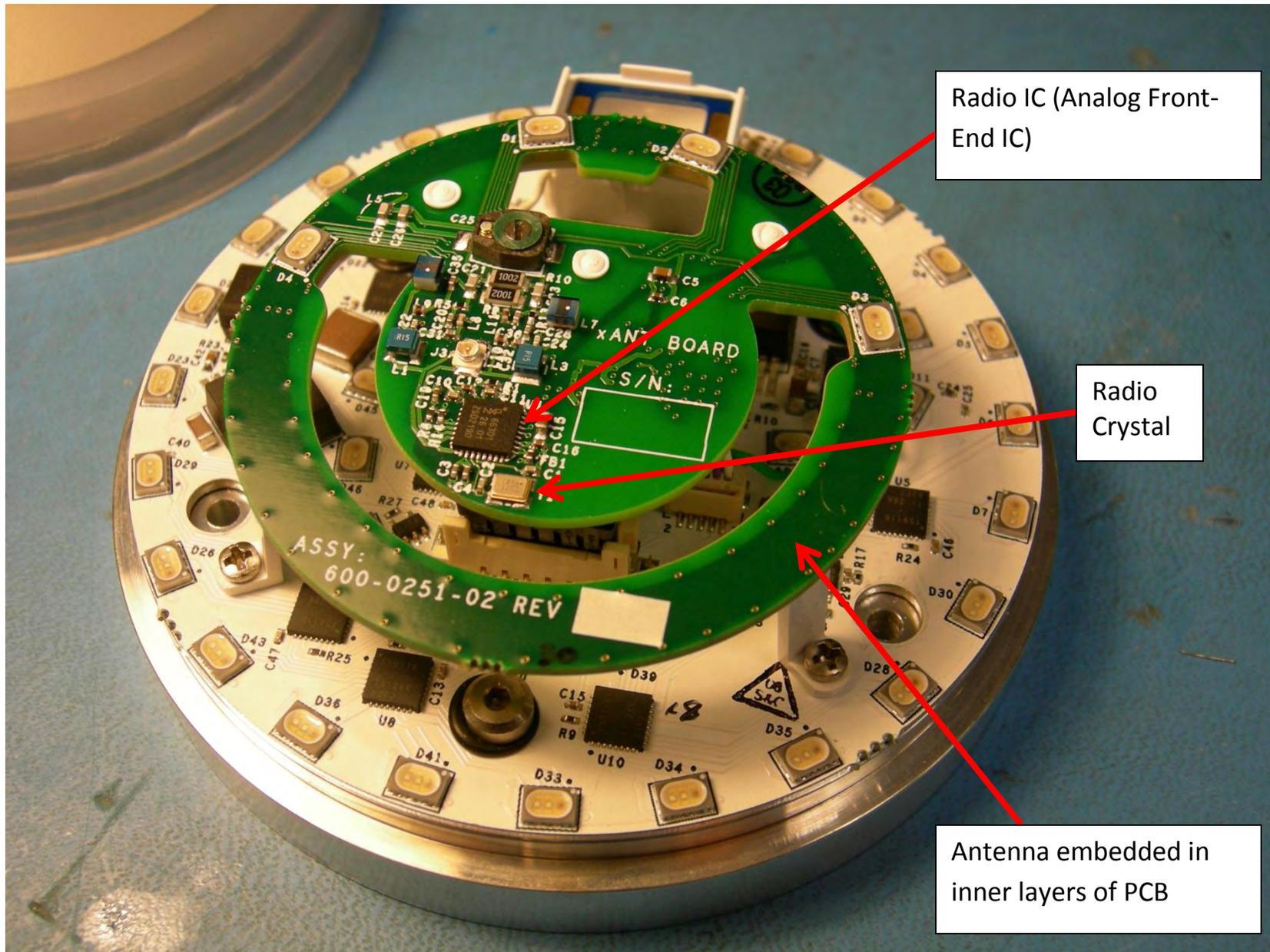
Radio IC (Analog Front-End IC)
