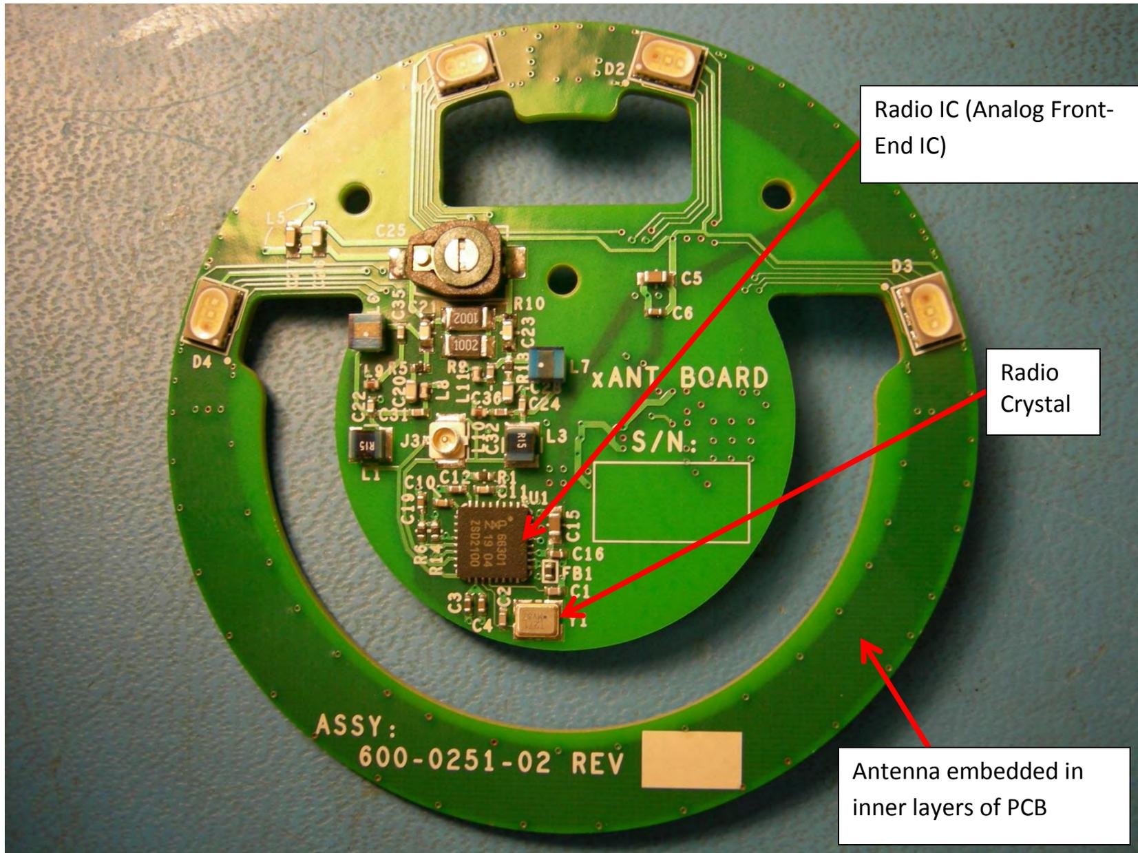
Radio IC (Analog Front-End IC)
