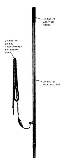
Fig. 8-Lumidor LP-570 Pole Probe
