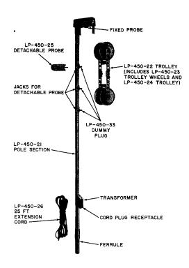
Fig. 11—Lumidor LP-455 Pole Probe
