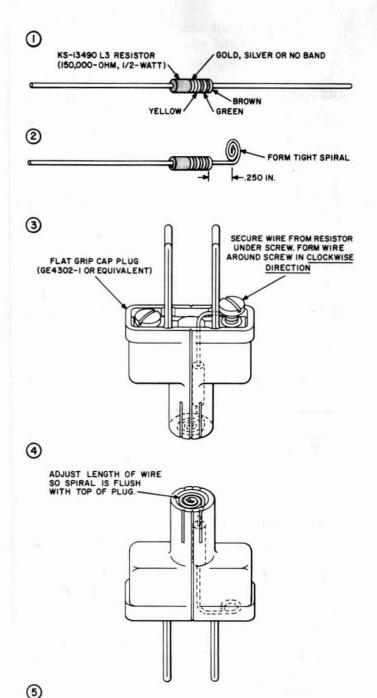
Fig. 4—Voltage Test Plug
