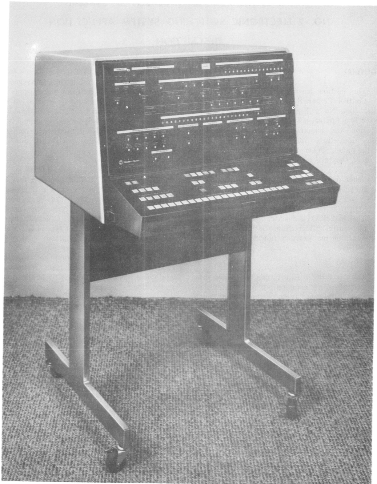
Fig. 1—No. 2 ESS/AIS SCCS Console
