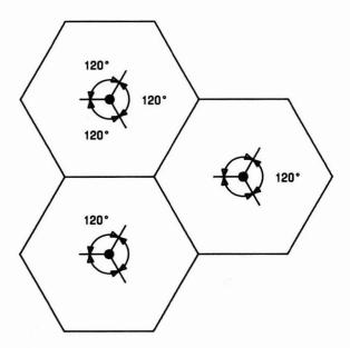
CELL SITE USING DIRECTIONAL ANTENNA
