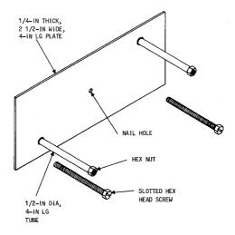
Fig. 8—♦Twin-Bolt Fastener♦
