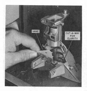
Fig. 3—Inserting Vane
