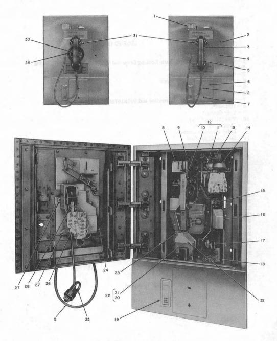
Fig. 2—2-Type Coin Telephone Set
