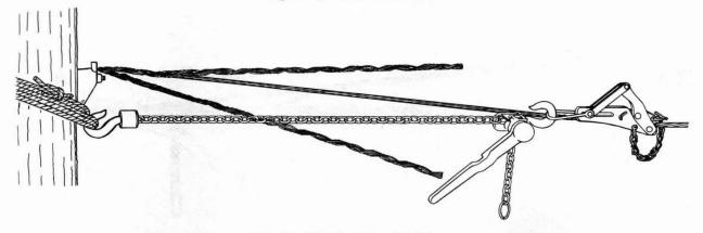
Fig. 6—♦Placing Strand Grip♦
