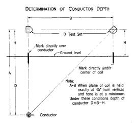
Fig. 10—Determining Conductor Depth
