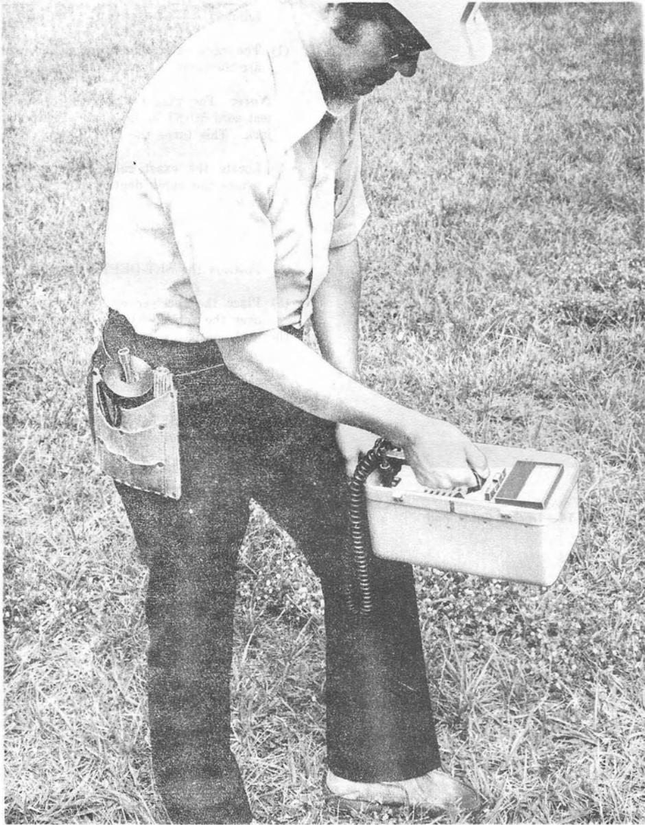
Fig. 15—Measuring Cable Depth
