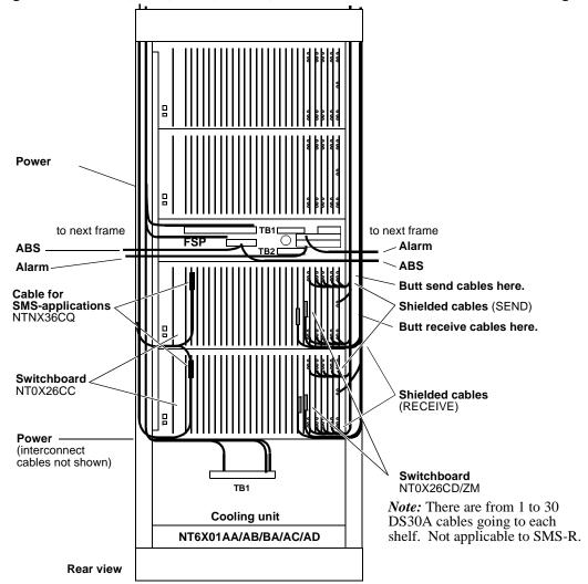
Figure 33 - Power, ABS, DS30, DS30A, and DS1/PCM30 and Alarm Cable Routing
