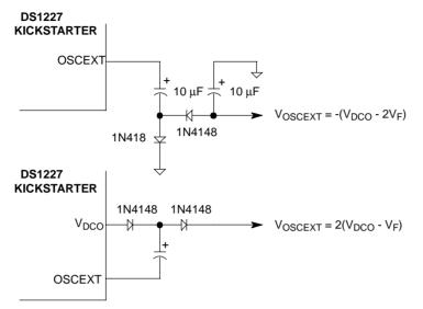
NOTE: V<sub>F</sub> = FORWARD 1N418 DIODE VOLTAGE
