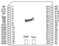
34-PIN POWERCAP MODULE (PCM) (USES DS9034PC POWERCAP)
