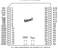
34-PIN POWERCAP MODULE (PCM) (USES DS9034PC POWERCAP)
