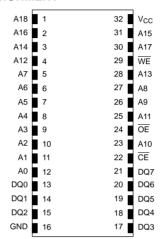
32-PIN ENCAPSULATED PACKAGE 740 MIL EXTENDED
