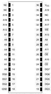
36-PIN ENCAPSULATED PACKAGE 740 MIL EXTENDED
