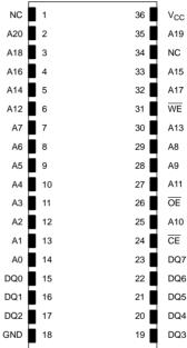
36-PIN ENCAPSULATED PACKAGE 740 MIL EXTENDED
