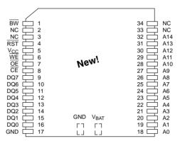
34-PIN POWERCAP MODULE (PCM) (USES DS9034PC POWERCAP)
