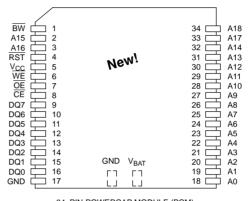
34–PIN POWERCAP MODULE (PCM) (USES DS9034PC POWERCAP)
