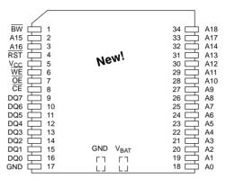
34-PIN POWERCAP MODULE (PCM) (USES DS9034PC POWERCAP)
